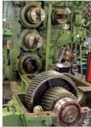
Renovering av kuggväxel till gummikalander, Trelleborgs Industri.
