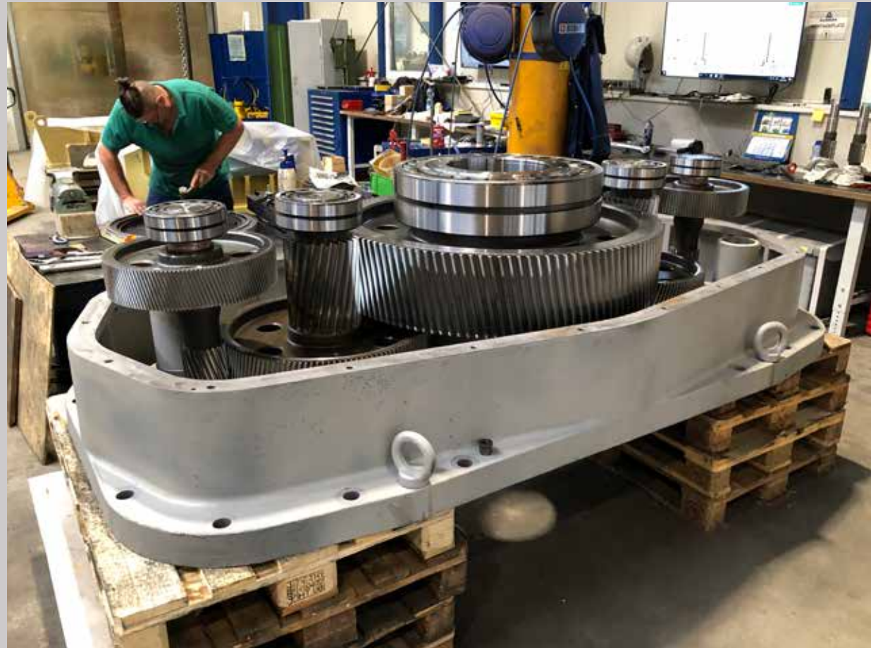
Totalreovering av Santasalo omrörarväxellåda.
