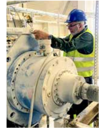
Uppmätning av växellåda för utbyte. Nordkalk.
