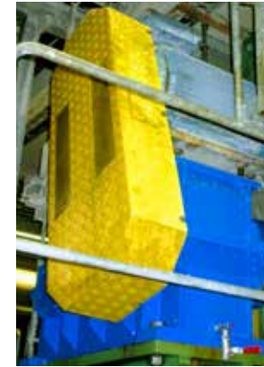
Eftertillverkning av Valmet-växlar till pappersmaskindriften, SCA.
